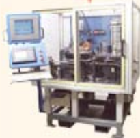
Станок для изготовления дизельных топливных инжекторов
